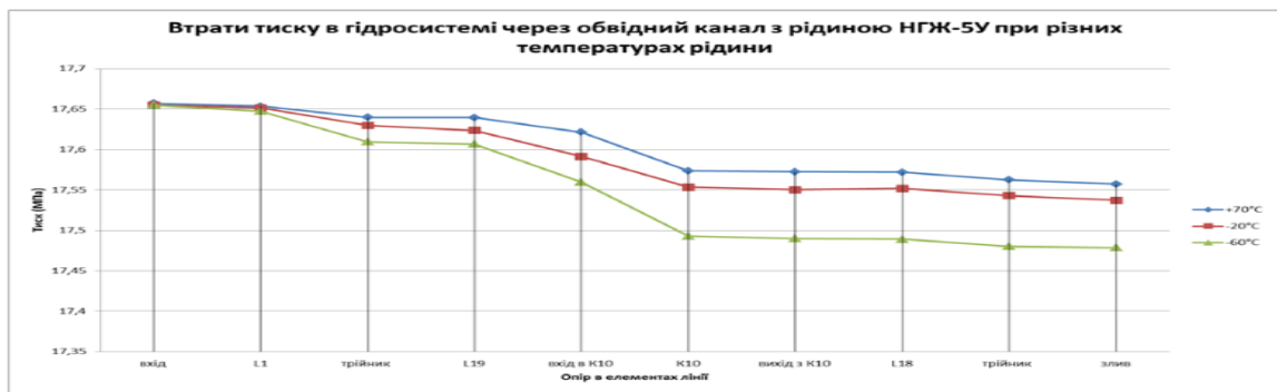
Рис.2.19. Графік втрат тиску в гідросистемі через обвідний канал. Як можна побачити, (рис.2.19.) коли рідина рухається через обвідний канал при температурі -60^{\circ}\text{C}
