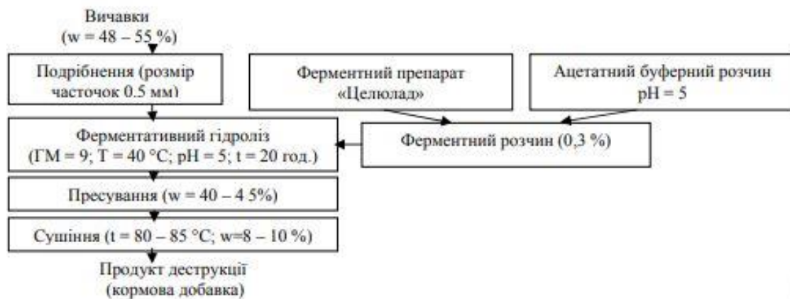
Рис. 2.1. Принципово-технологічна схема одержання кормової добавки з вичавків
