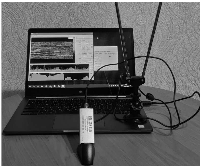
Рис. 4.11. Експериментальна установка на базі приймача RTL-SDR V3 та програмного забезпечення TempestSDR
