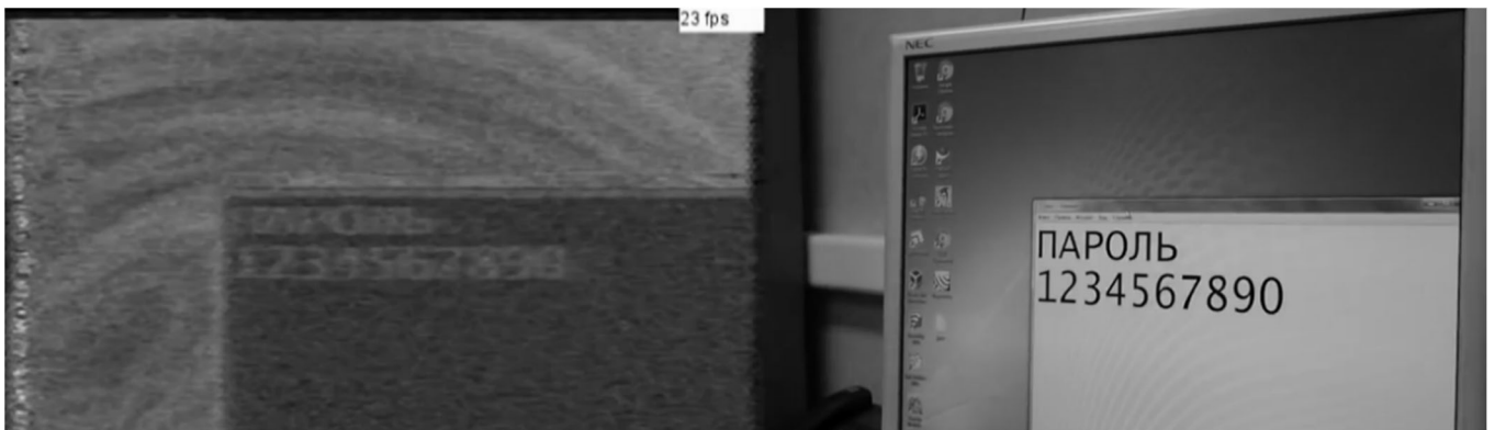
Рис. 4.12. Демонстрація зняття ПЕМВН з інтерфейсу VGA з роздільною здатністю 1280x1024 пікселів та частотою оновлення 75 Гц (на частоті 455 МГц і відстані 7,5 метрів) за допомогою програми TempestSDR та приймача RTL SDR V3
