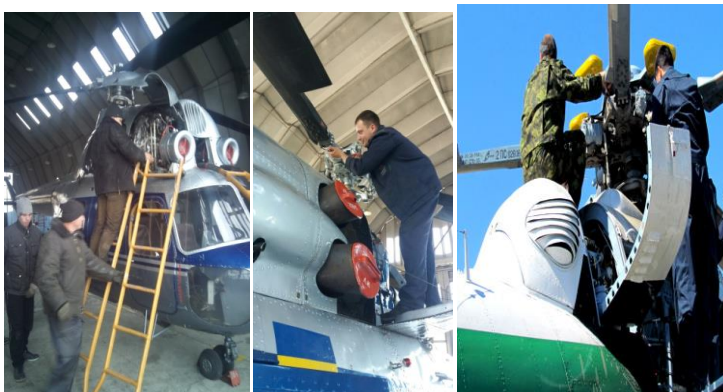
Рис.1.21. Проведення регламентних робіт на ПС
