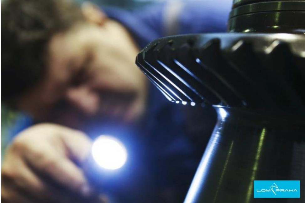
Рис.1.18. Візуальне виявлення пошкоджень та дефектів на агрегаті ПС
