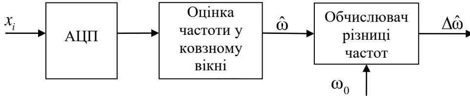
Рис. 10. Структурна схема детектора частоти на основі оцінки частоти
