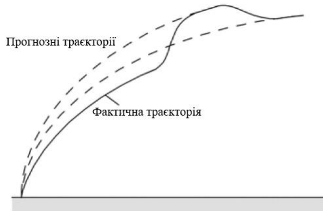
Рис.1.5. Схема траєкторного руху ЛА в атмосфері з термінальним керуванням
