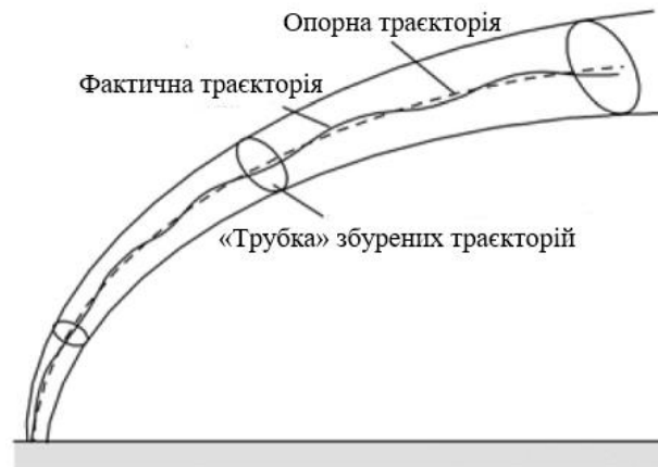
Рис.1.4. Схема траєкторного руху ЛА в атмосфері з відслідковуванням номінальної траєкторії
