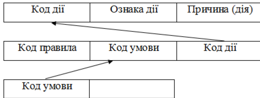
Рис. 4.9. Схема зв'язків відносин бази знань ЕСДТОБС
