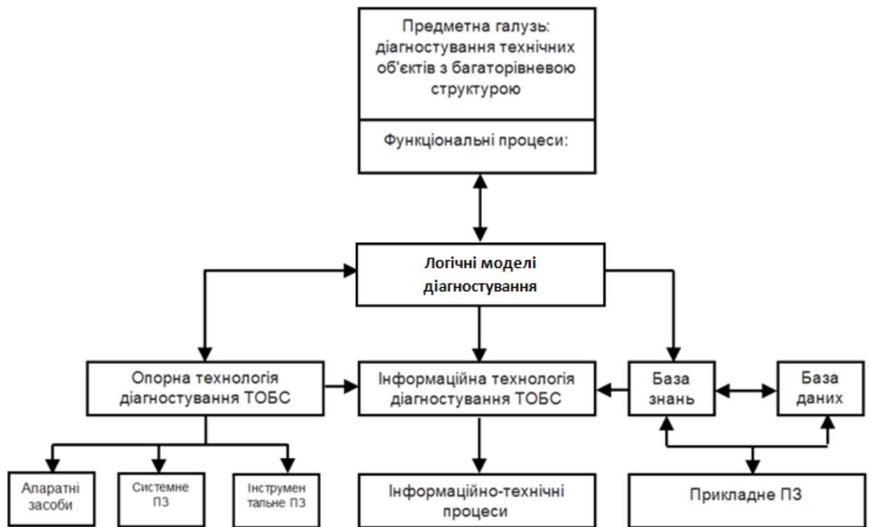
Рис. 4.4. Структура інформаційної технології діагностування ТОБС
