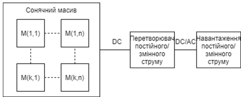
Рис. 2.12 – Схема включення централізованого інвертора
