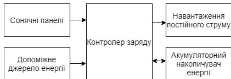
Рис. 1.2 – Приклад спрощеної структури ГВЕС постійного струму
