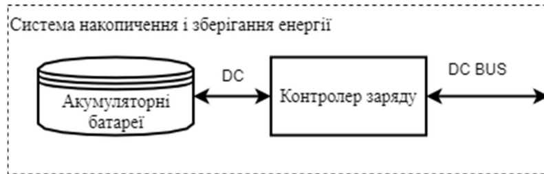
Рис. 1.8 – Структура блоку акумуляторної системи акумулювання
