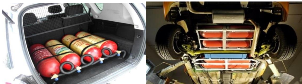
Рис. 1.2. Розташування балонів в переобладнаному автомобілі і в заводському виконанні
