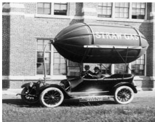
Рис. 1.5. Газобалонні автомобілі зі збереженням газу при низькому тиску
