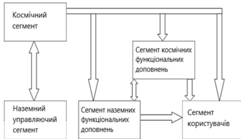
Рисунок 1.2 Структура супутникової радіонавігаційної системи
