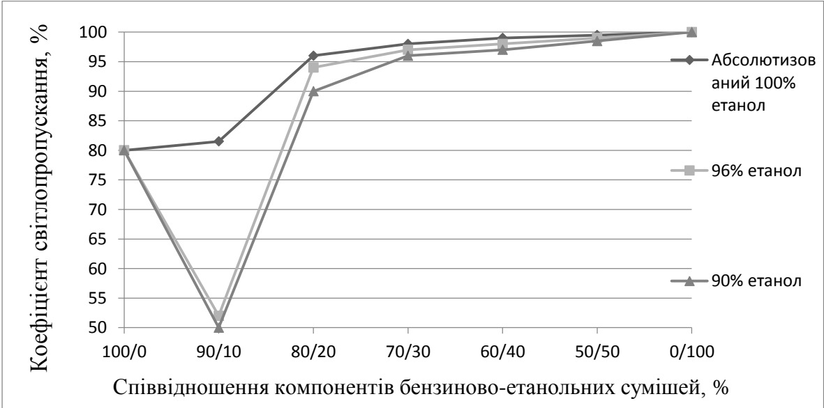
Рис. 3.17. Залежність світло пропускання БЕС від ступеня абсолютизації етанолу та його вмісту в суміші
