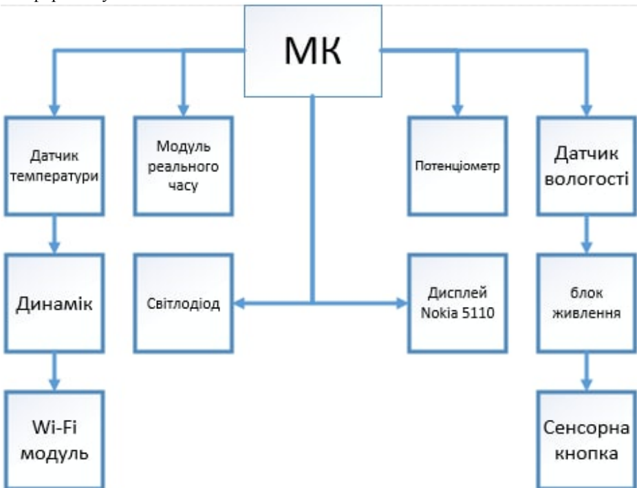
Рисунок 1 – структурна схема пристрою для догляду за рослинами.
