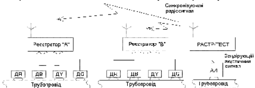
Рис. 1. Розгортання системи РАСТР-1М на трубопроводі.
