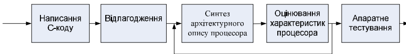
Рис. 2. Схема процесу проектування спеціалізованих процесорів на основі системи автоматичного синтезу їх архітектурного опису
