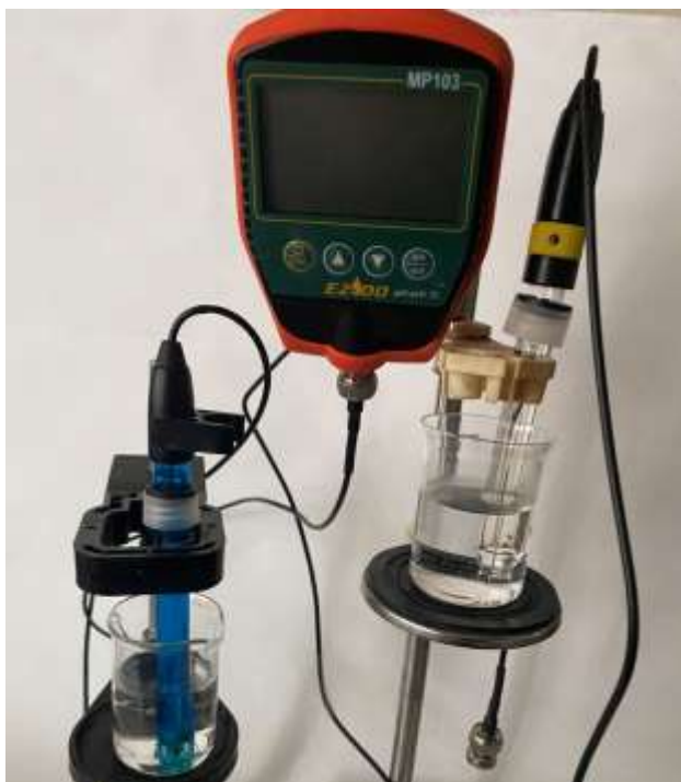
Рис. 2.2. Іонімір фірми «EZODO» для вимірювання рН і Eh
