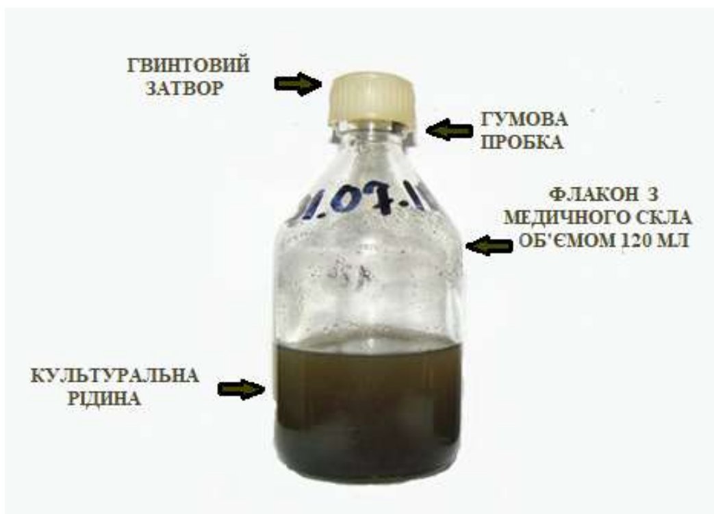
Рис. 3.3. Герметичний флакон для мікробного гідролізу тканин комах
