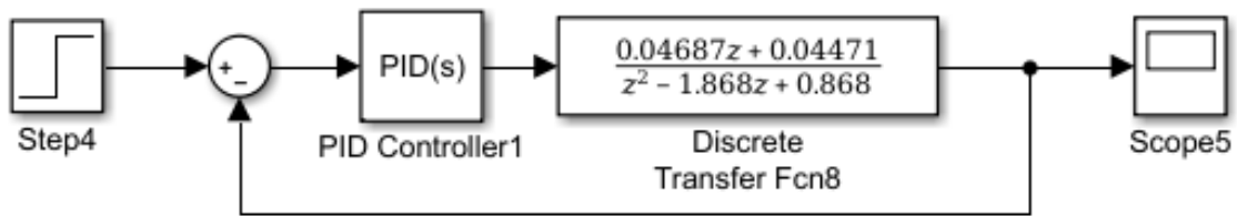
Рис.3.3. Структурна схема ЦСАК ДПС налаштована через метод PID-Tuner
