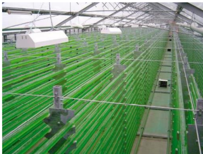
Рис. 2.3. Зображення закритих фотореакторів для культивування спіруліни ( Spirulina platensis )
