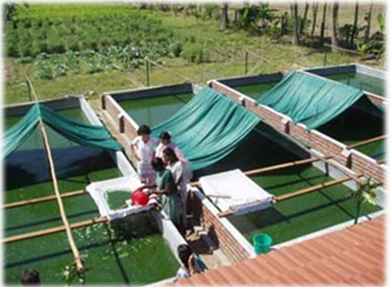
Рис.2.2. Зображення відкритого басейну для культивування спіруліни ( Spirulina platensis )
