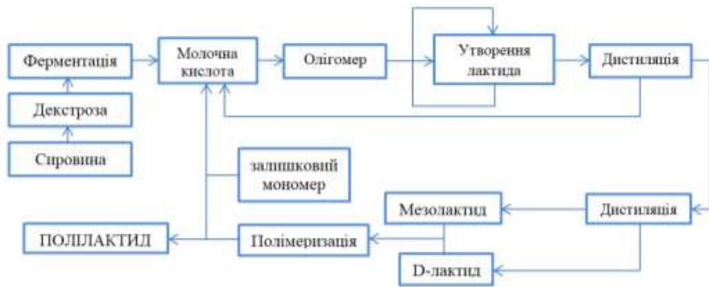
Рис.2.4.3. Схема одержання полілактиду
