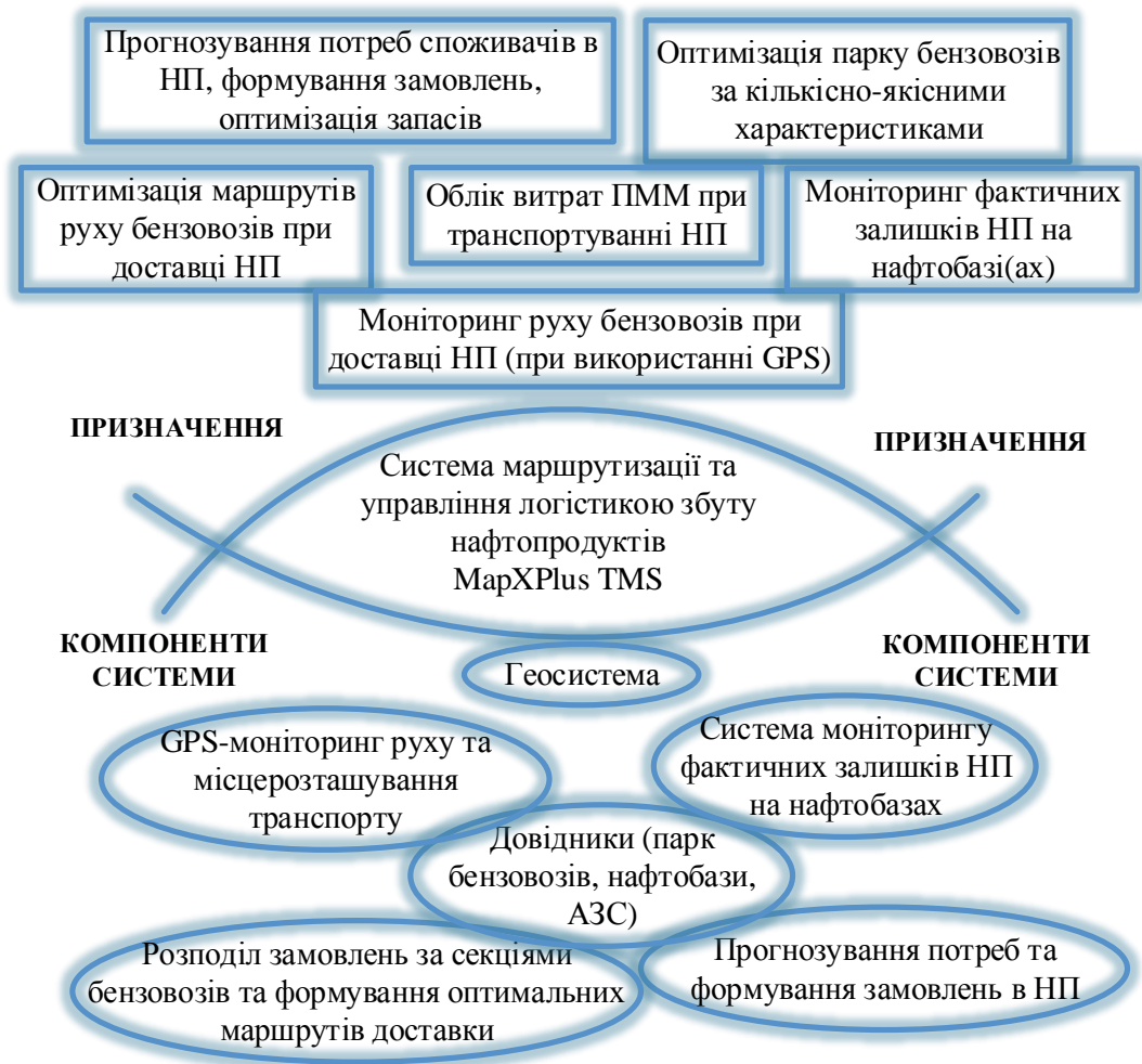
Рисунок 3.9 – Призначення та компоненти MapXPlus TMS
