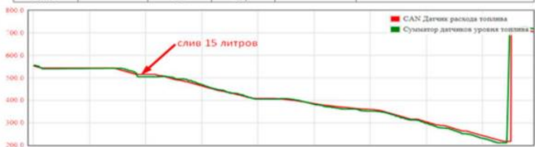
Рисунок 3.5 – Зразок звіту сумісного контролю палива бензовозом, що обладнаний GPS навігацією
