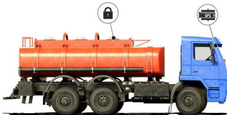
Рисунок 3.7 – Встановлення датчиків відкриття кришки люку бензовозу, що обладнаний GPS навігацією
