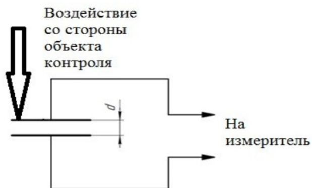
Рис.1.4. Принцип роботи датчика лінійного переміщення (а)
