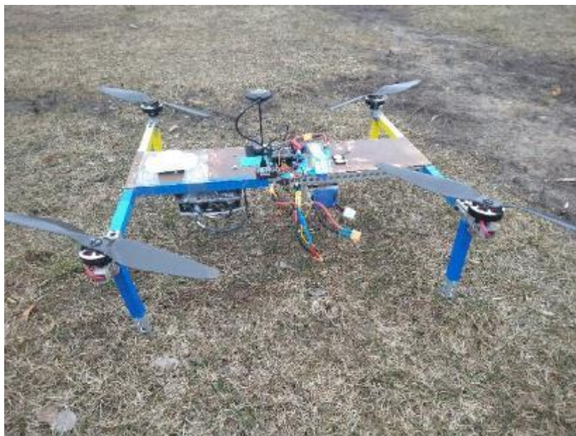
Рис 5.1 – Бортова підсистема апаратно-програмного комплексу встановлена на квадрокоптері.
