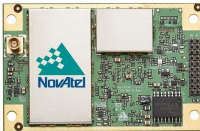
Рис. 4.2 – Зовнішній вигляд навігаційного приймача Novatel OEM-719
