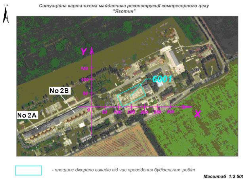
Рисунок 1.7 - КС Яготин: КЦ №2 (2А та 2Б) та площадка демонтованого КЦ №1, що планується для встановлення нових ГПА звіт з ОВД «Яготин» [73].
