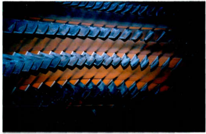
Рисунок 2.5 - Забруднення лопаток НА-4, НА-5, НА-6 і НА-7 у верхній половині статора
