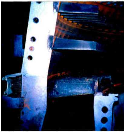
Рисунок 2.4 - Забруднення лопаток ВНА, НА-1 НА-2 у верхній половині статора
