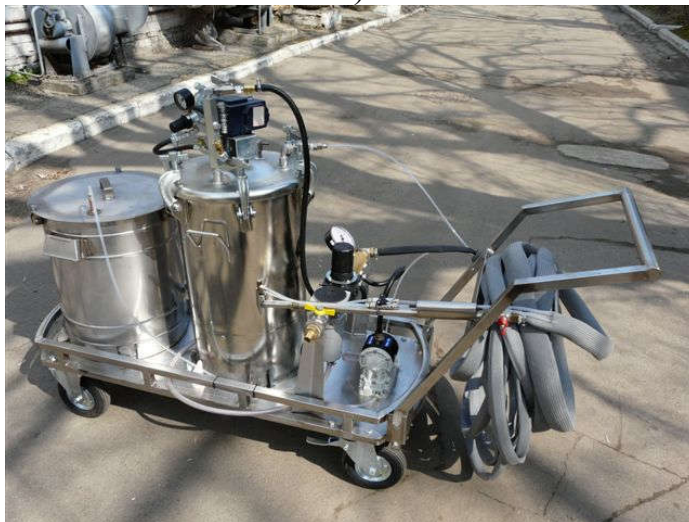
Рисунок 2.10 - Пристрій для отримання льоду: а) принципова схема; б) експериментальна установка
