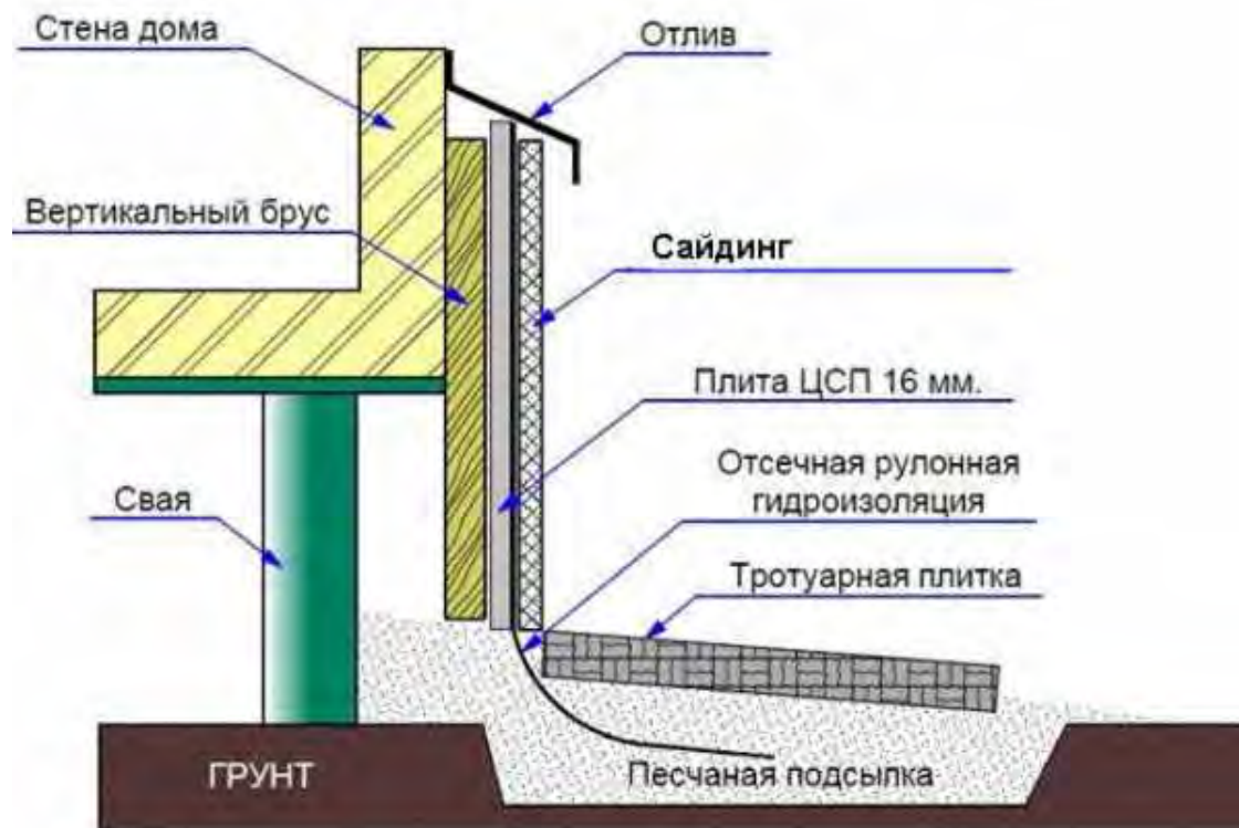
Рис. 2.3. Приклад виконання цоколя
