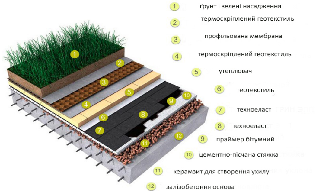
Рис. 2.13. Улаштування конструкції плоскі зеленої покрівлі.
