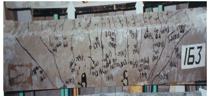
Рис. 4. Общий вид картины трещинообразования железобетонной конструкции ІБ3 первой серии
