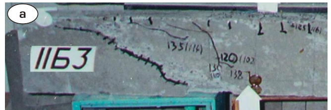
Рис. 4. Общий вид картины трещинообразования железобетонной конструкции ІБ3 первой серии
