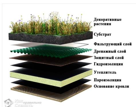
Рис. 2.6. Влаштування зеленої покрівлі
