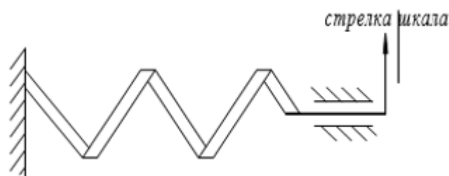
Рис. 16 Біметалічний термометр у виді гвинтової пластини.
