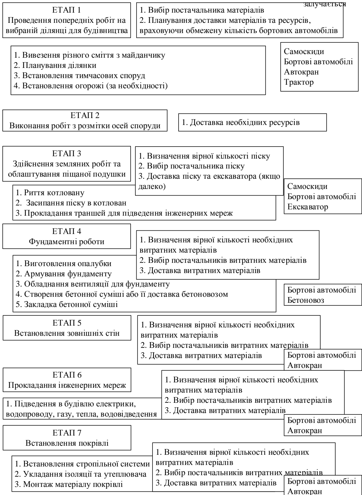
Рисунок 2.8 – Будівельні процеси ПП «Консоль» та їх логістична підтримка
