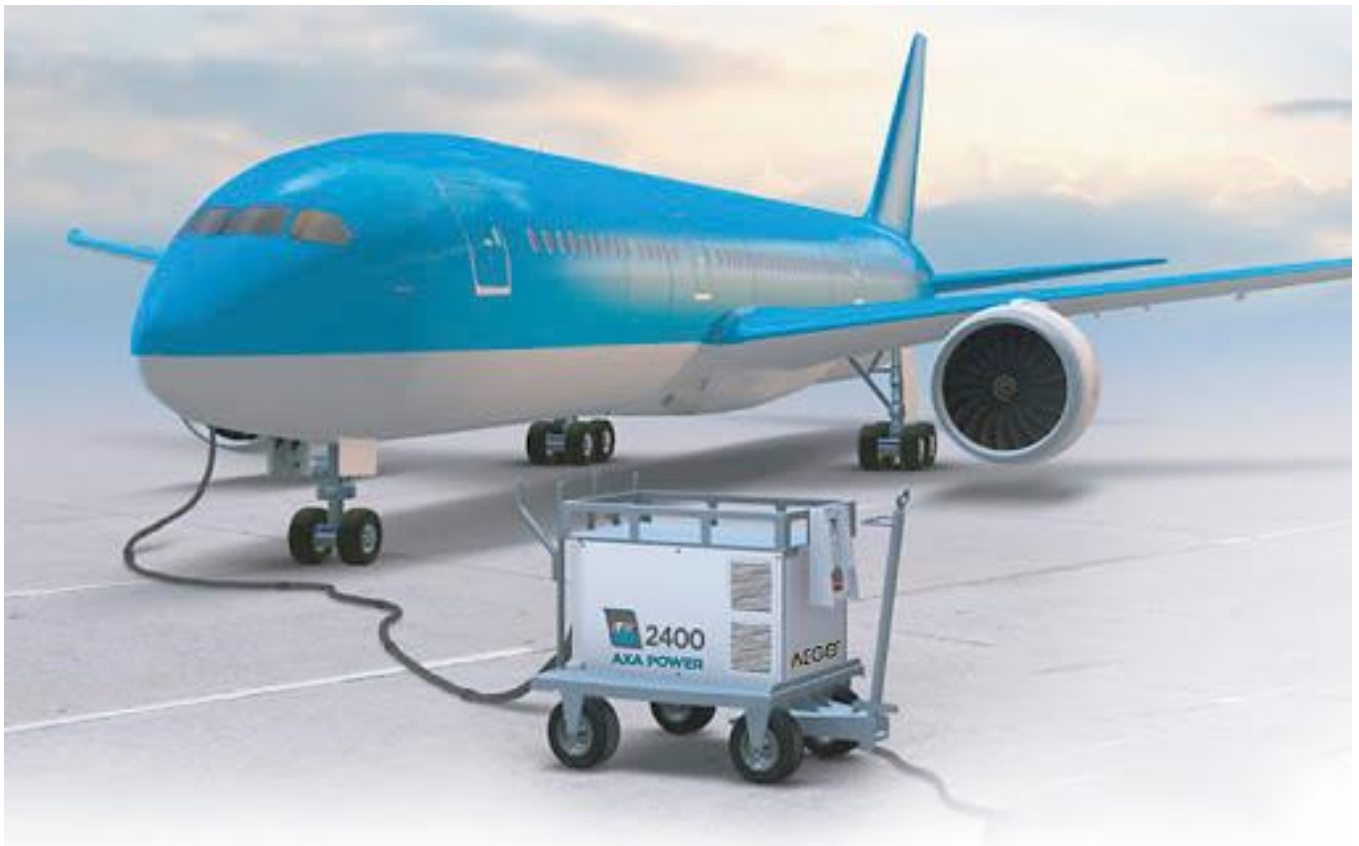
Рис.3.2.1.1. Наземне джерело живлення
