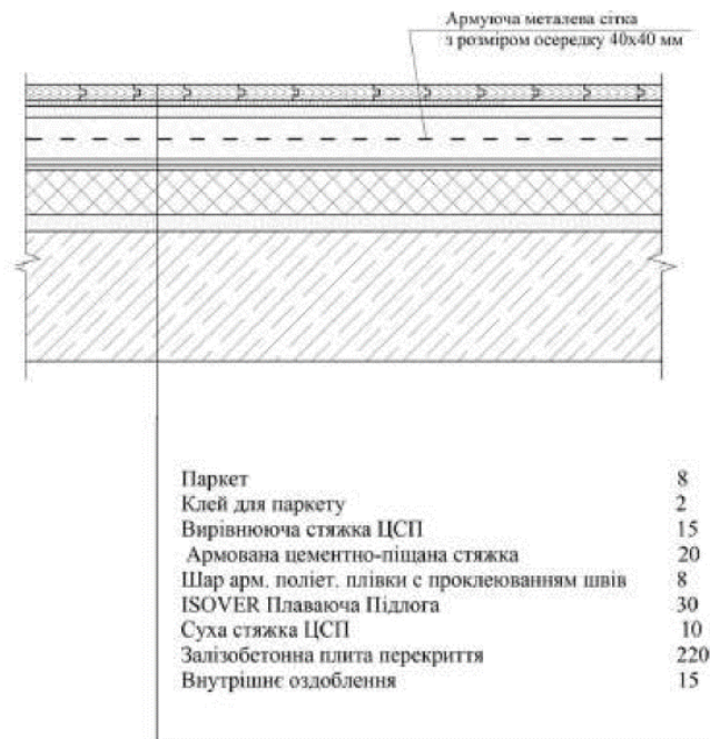
Рис.5.7. Схема міжповерхового перекриття
