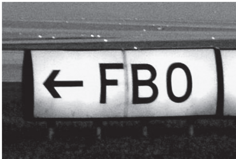
Ilustracja 74. Znak miejsca przeznaczenia
