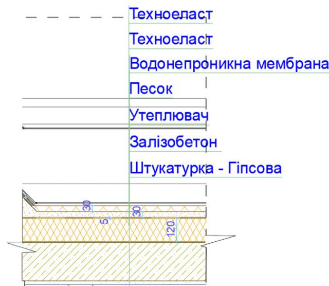
Рис. 2.12 Вузол покрівлі
