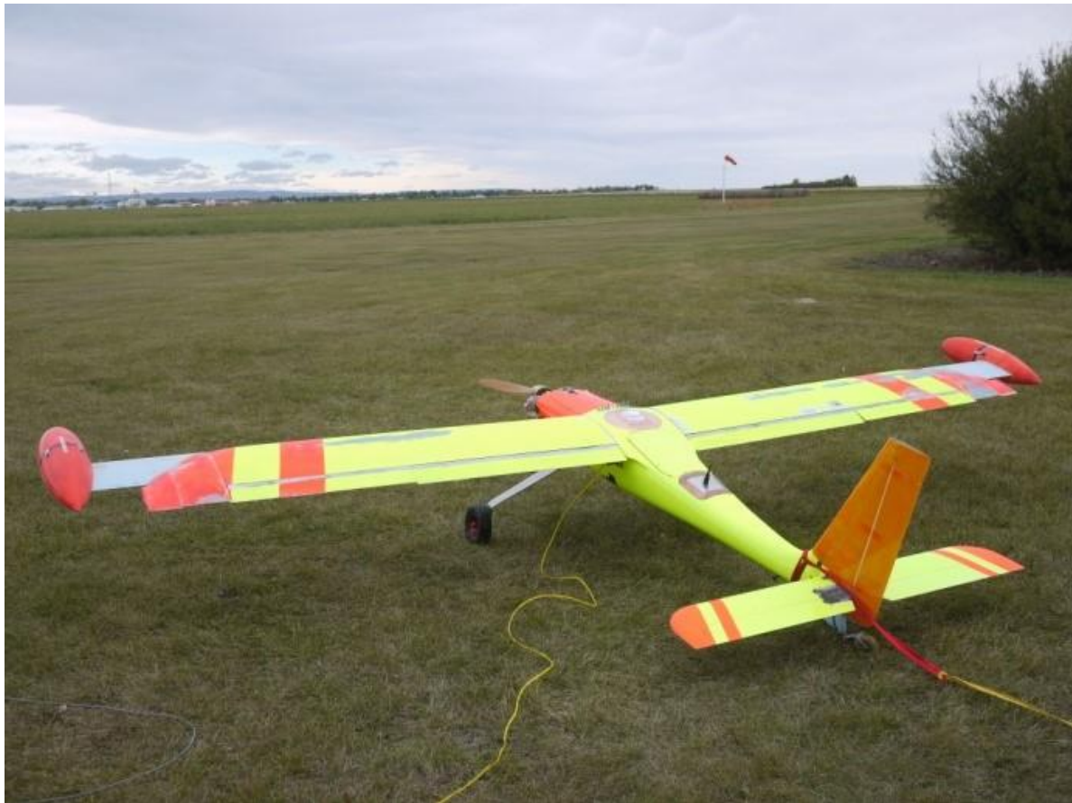
Рисунок 4.1 - ДПЛА горизонтального зльоту-посадки НТОЛ з встановленими на краях крил цезієвими магнітометрами [32]
