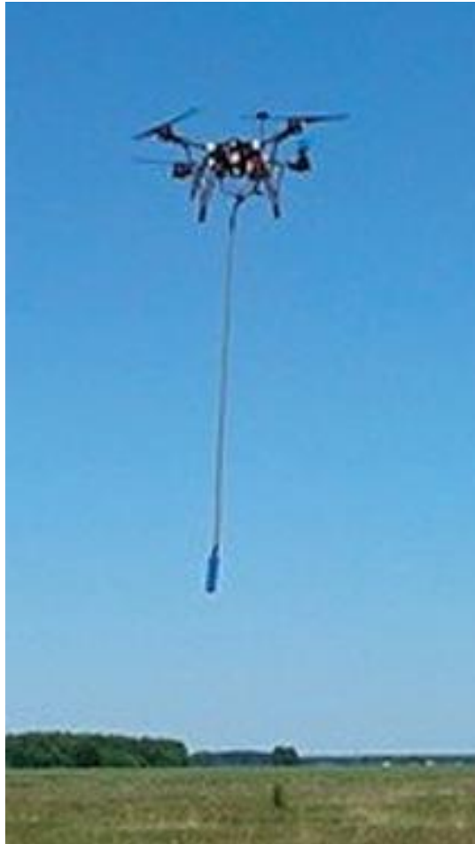
Рисунок 4.6 - Схема дистанційного дослідження магнітних аномалій на основі ферозондового магнітометра на борту ДПЛА мультикоптерного типу [36]
