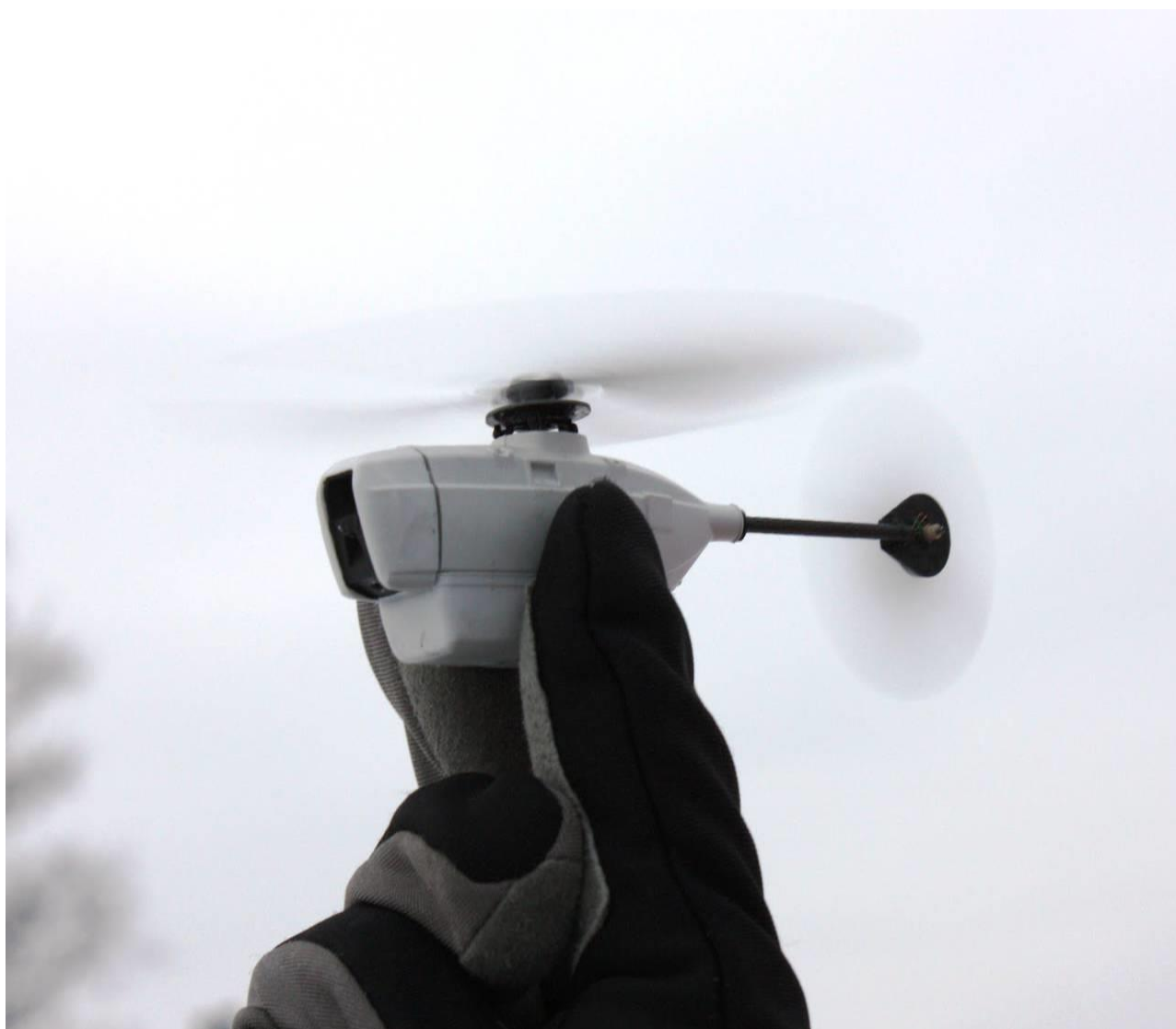
Рисунок 1.2 – Безпілотний літальний апарат PD-100 Black Hornet Nano (Норвегія) [5]
