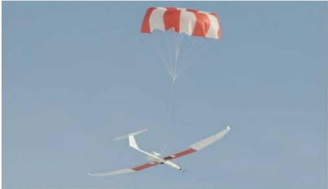
Рисунок 1.2 – Посадка БПЛА за допомогою парашута
