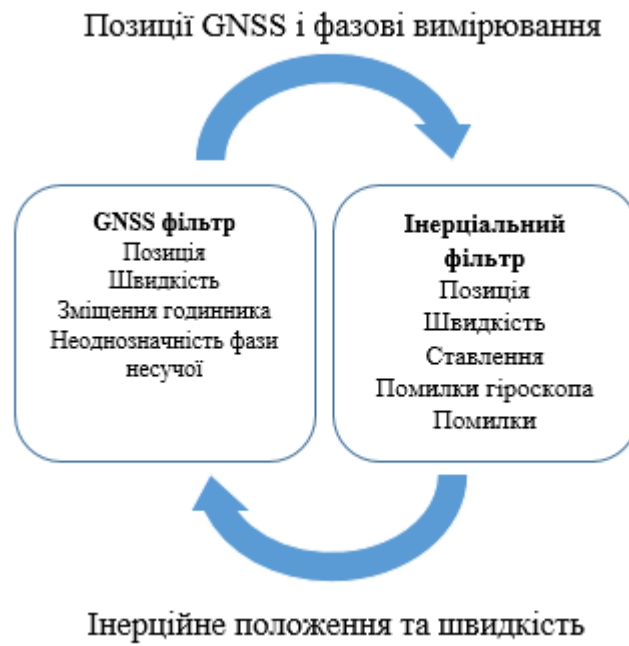
Рисунок 3.11 - Тісно пов'язана система GNSS+INS
