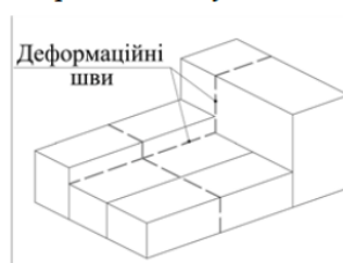
Рис. 5. Аксонометрична схема ОВБ (приклад спряження різновисоких прогонів)
