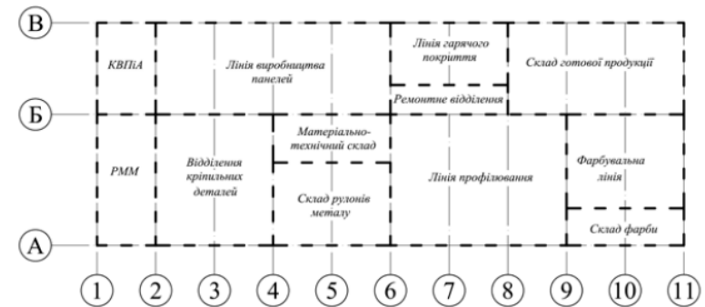
Рис. 10 Приклад компоновки технічних дільниць цеху ОВБ
