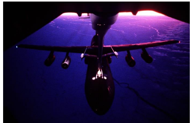
Рис. 1.22. Літак-паливозаправник McDonnell Douglas KC-10 Extender USAF виконує дозаправлення військово-транспортного літака Lockheed C-141 Starlifter USAF у повітрі
