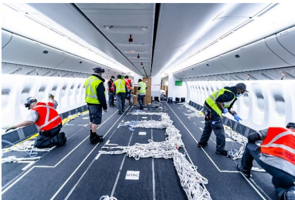
Рис. 1.5. Фіксуючі місця та вантажні сітки на верхній палубі літака
