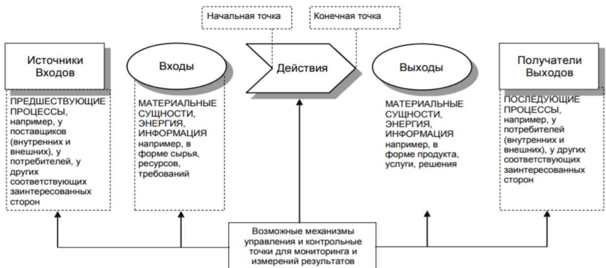
Рис. 2.2. Загальна схема процесу та його контрольних точок [15]
