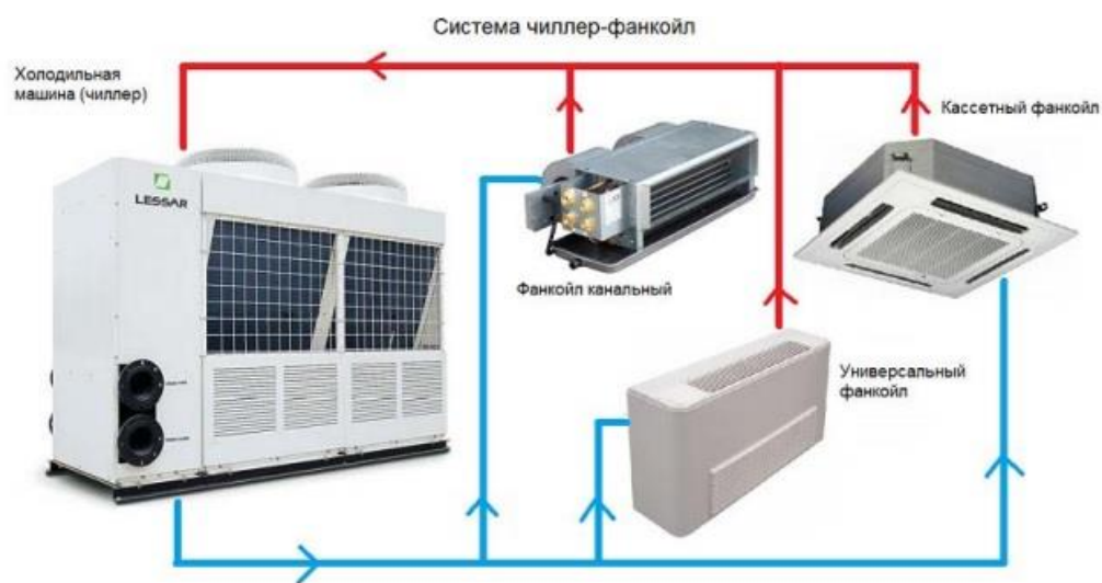
Рис. 4.15. Приклад роботи системи «чиллер - фанкойл»
