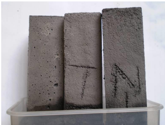
Рис. 2.19. Зовнішній вигляд зразків після випробування на визначення висолоутворення
