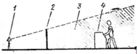
Рис. 5.2. Екранування шуму: 1-джерело шуму, 2-екран, 3-звукова тінь, 4-робоче місце
