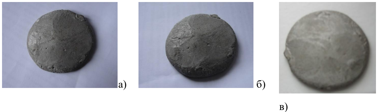
Рисунок 2.18. Зразки цементного тіста на основі золи гідро видалення 3 після випробування на рівномірність зміни об'єму: а) склад № 1; (б) – склад № 5; (в) – склад № 10.
