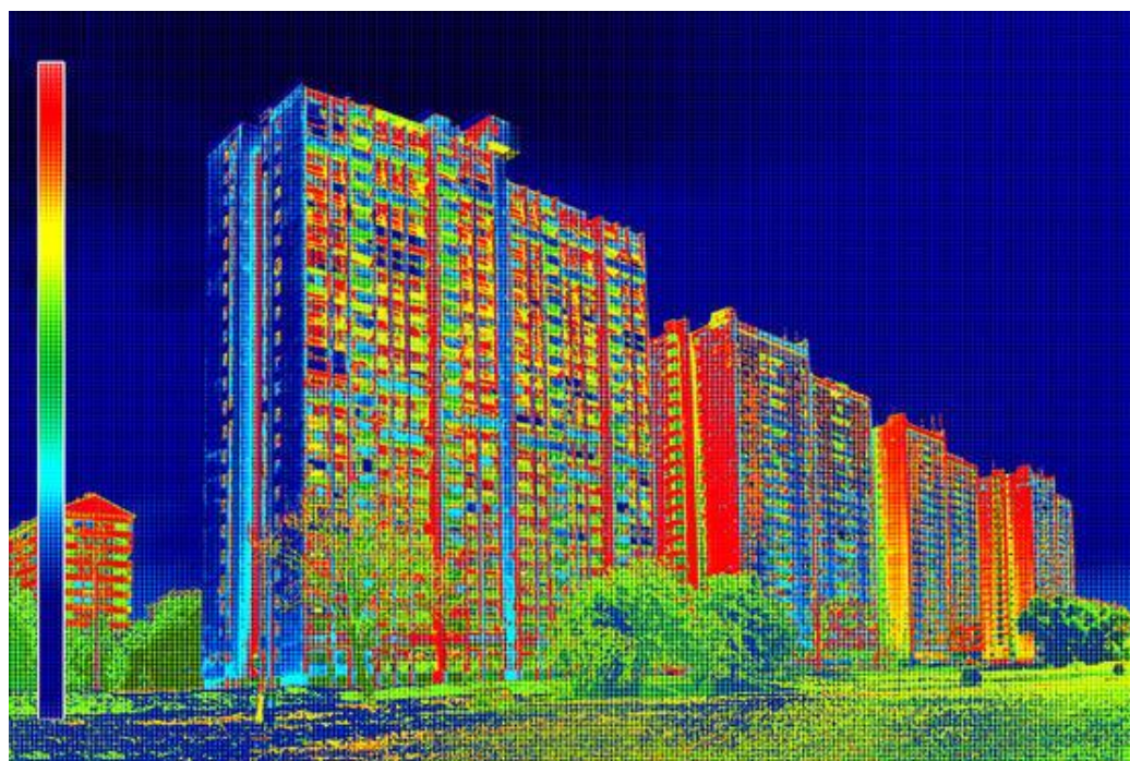
Рис. 9.1. Тепловізійне зображення фасаду: витрати енергії
