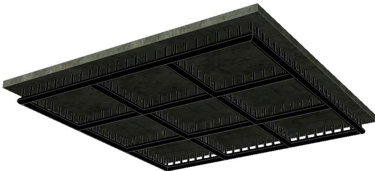
Рис. 10.21. Сталезалізобетонні плити з армуванням трубами
