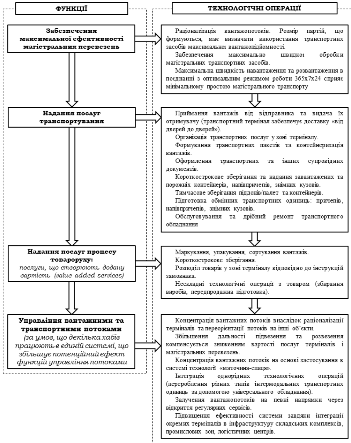
Рис. 1. Основні технологічні операції, що виконуються в мультимодальних транспортних терміналах
