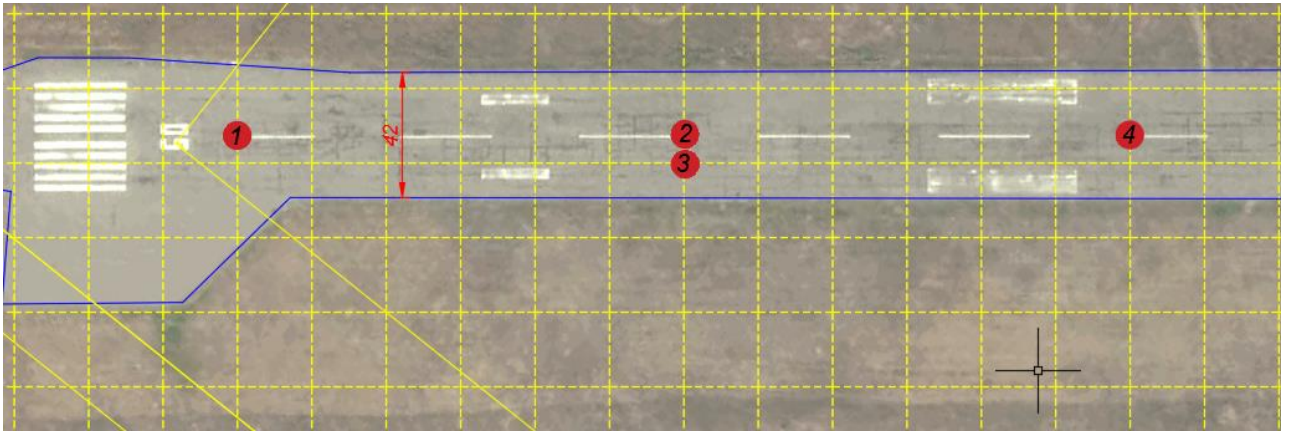
Рисунок 2.8. Схема нумерації та місця відбору кернів №1, №2, №3 та керну №4
