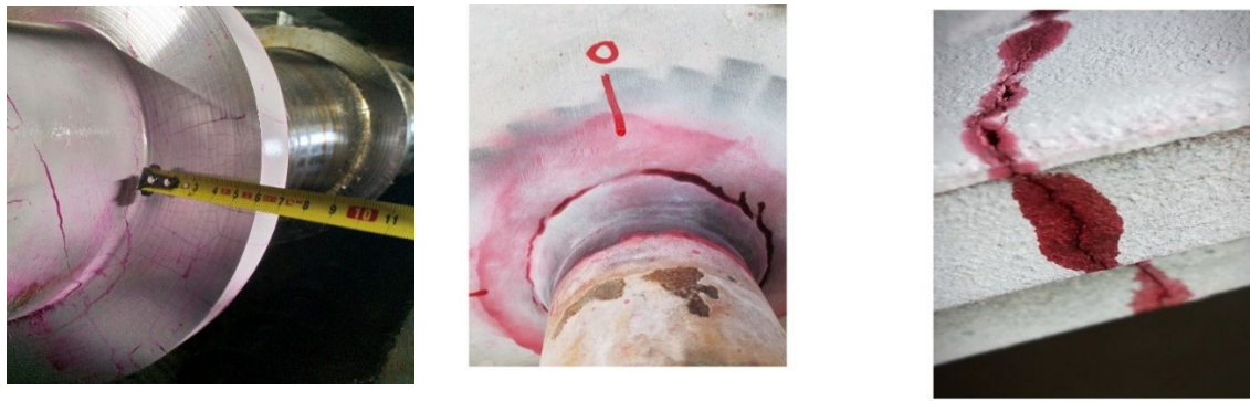
Рис.2.3. Вигляд лінійних індикацій капілярного методу контролю
