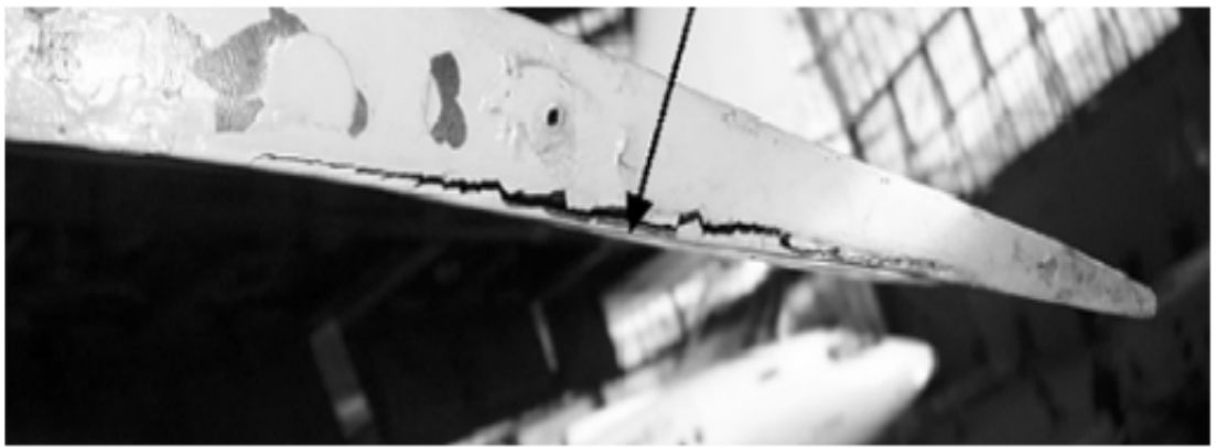
Рис. 2.17. Відшарування обшивки сотової панелі.
