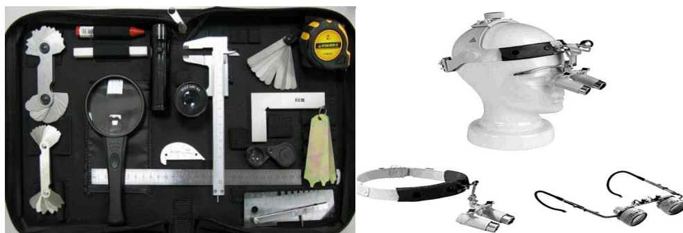
Рис. 2.1. Набір інструментів для візуального контролю механічних пошкоджень (ліворуч) та оптичні прилади б)
