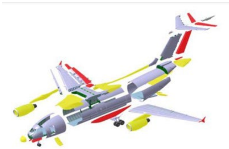
Рис. 2.25. Застосування ПКМ на літаку Ан -178, жовтий колір – зі склопластику, червоний – із вуглепластику
