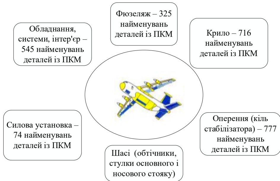
Рис. 3.4. Використання полімерних композиційних матеріалів в конструкції літака АН-70
