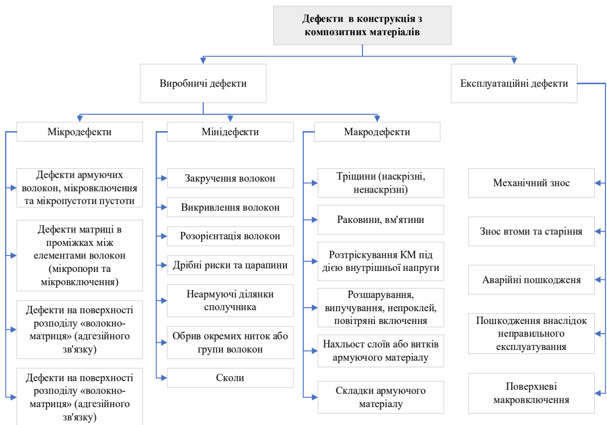
Рис. 2.7. Класифікація видів дефектів в композитних матеріалів
