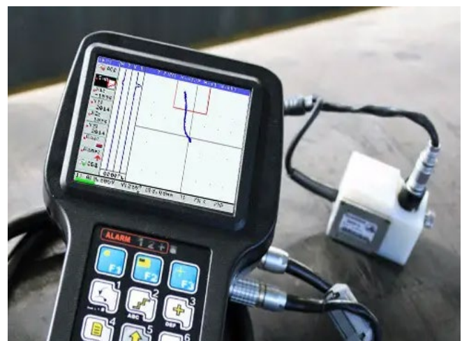
Рис. 2.4. Зображено фізичний принцип роботи ВСП (а) та вигляд дефекту на екрані дефектоскопу (б)
