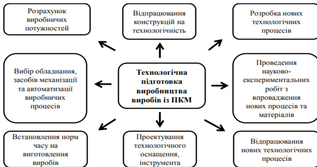
Рис. 1.7. Технологічна підготовка виробництва виробів із ПКМ
