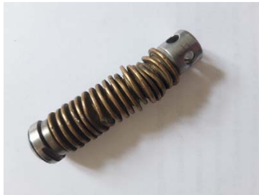
Рис. 1.7 Мастильний фільтр на вході в опору газотурбінної установки
