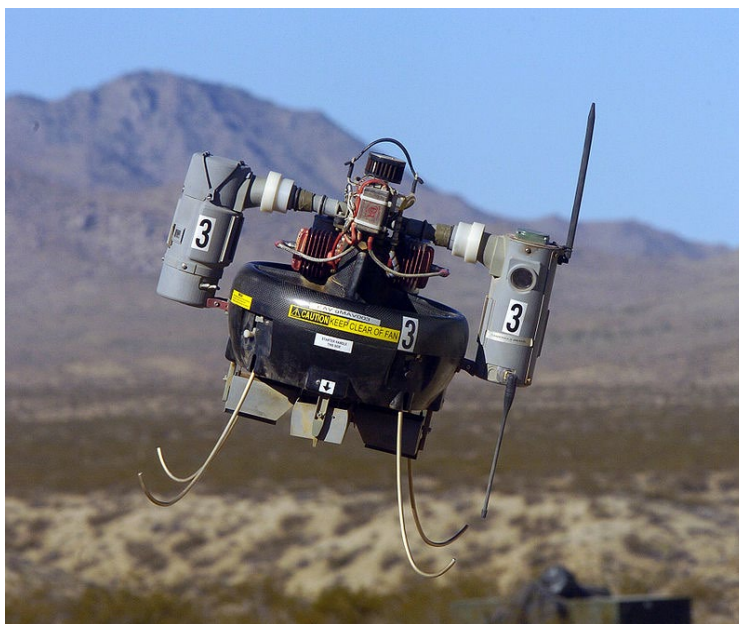
Рис. 2.2 Мікро- літальний апарат (мікро-БПЛА, MAV) , призначений для перенесення систем відео- та фотозйомки
