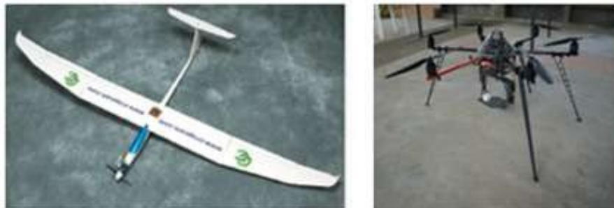
Рис. 1.1.(a) БПЛА з нерухомим крилом (ліворуч) і (b) Поворотний БПЛА (праворуч)
