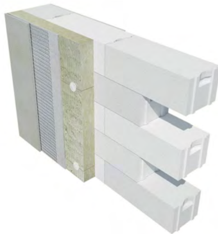
Рис. 5.6. Приклад утеплення стін з газоблоку [82]
