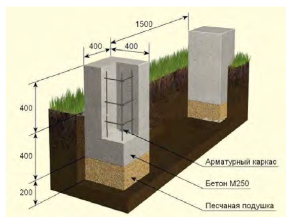
Рис. 5.4. Монолітний стовпчастий фундамент [64]
