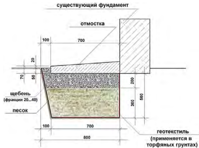
Рис. 5.5. Вузол влаштування відмостки по периметру будівлі [21]
