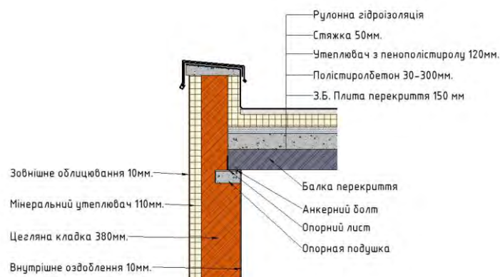
Рис. 5.10. Типова конструкція плоскої покрівлі
