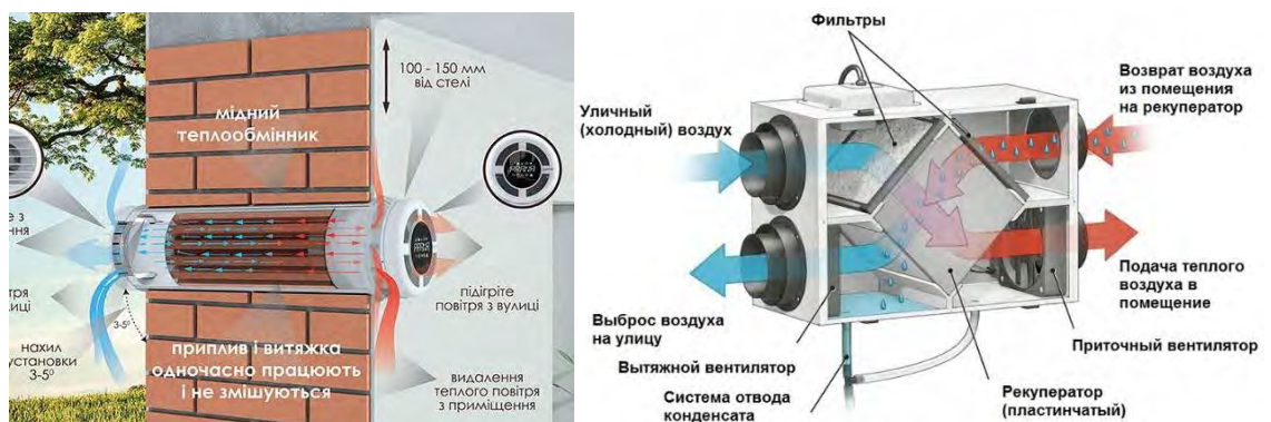
Рис. 5.12. Монтування та процес роботи рекуператорів
