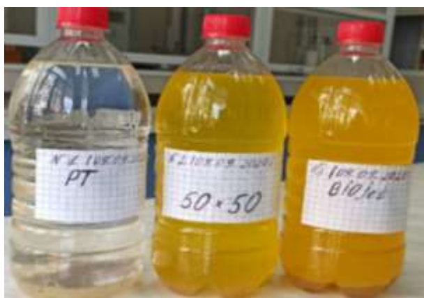
Рис.3.27. Зразки палива (вода+мікробіологічне забруднення) станом на 09.09.2020
