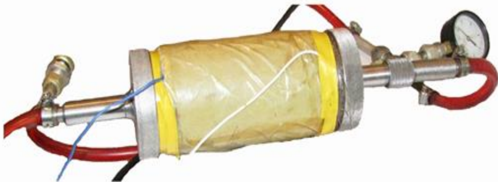
Рис. 3.7. Пристрій для підвищення протизносних властивостей ПММ (фотографія)
